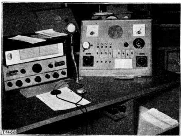
Fig. 10. Telefoniekspeditionsplads med modtager og betjeningspult for terminaludstyr. Thorshavn kystradio-station.
